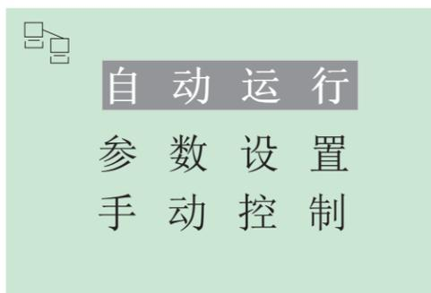
：符号表示参数设置时所有电容的参数设置一样，只设置一个电容的参数，其余的电容参数自动修改过来（所有电容必须上电，并且通讯连接）。
